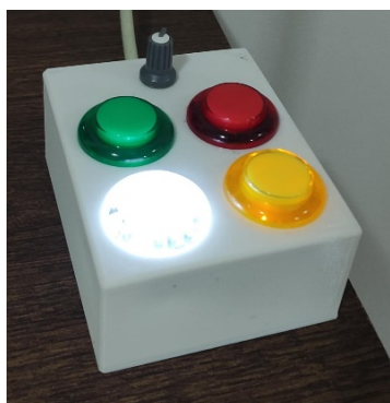
Figura 2. Controle de comandos com botões retroiluminados acessos
