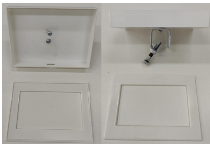
Figura 5. Capa de revestimento do monitor e chapa de aço carbono com parafuso
