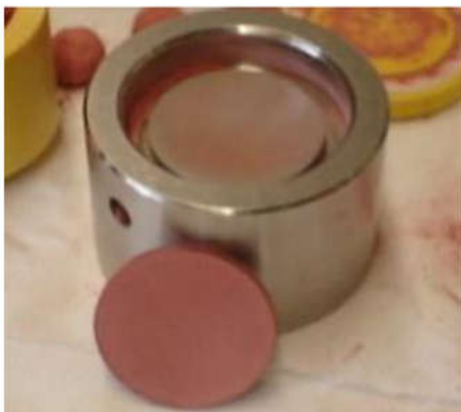
Fig. 5. Modelo de uma pastilha de argila para submissão ao FRX e anel de aço [35]
