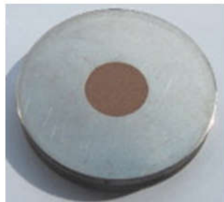
Fig. 4. Demonstração de uma amostra de pó de argila sobre uma placa de vidro para submissão ao DRX [33].
