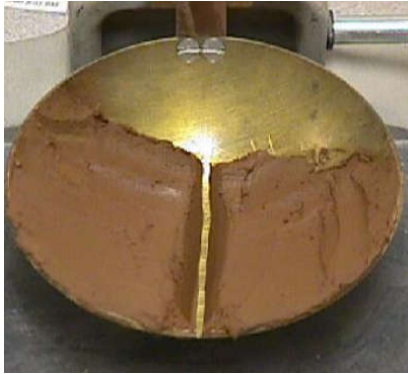
Fig.1. Exemplo de uma amostra de argila na concha do aparelho Casagrande [14]
