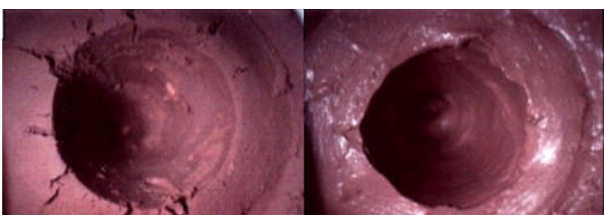
Fig. 2 Amostra de argila e limites de Atterberg, adaptado de [17]
