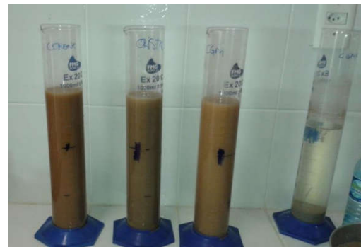
Fig. 3. Demonstração de uma preparação de amostras de argila em provetas para realização do ensaio de DRX [7]
