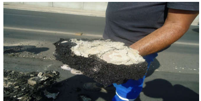
Figura 14. Capa de recobrimento do paralelepípedo com argamassa de cimento e areia
