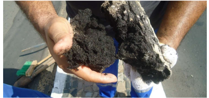
Figura 13. Baixa resistência da massa asfáltica
