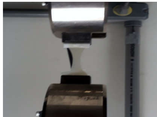
Figura 3. Preparação e método de análise de tração dos filmes
